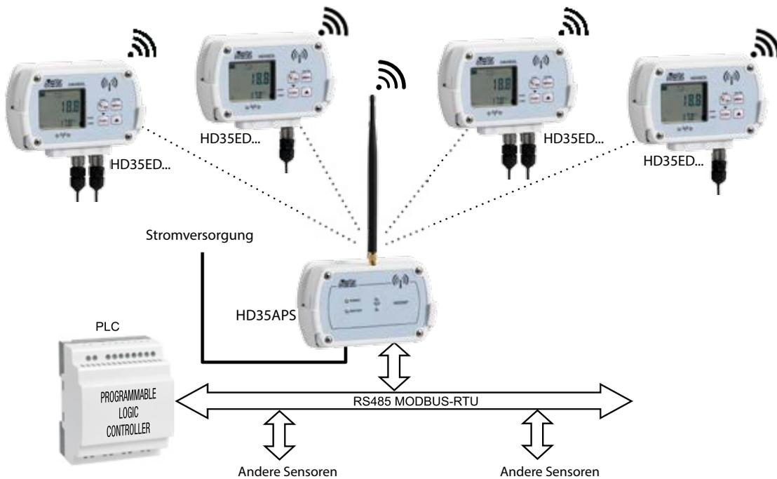
Verbindung von PC und Basiseinheit über ein RS485 MODBUS-RTU Netzwerk
