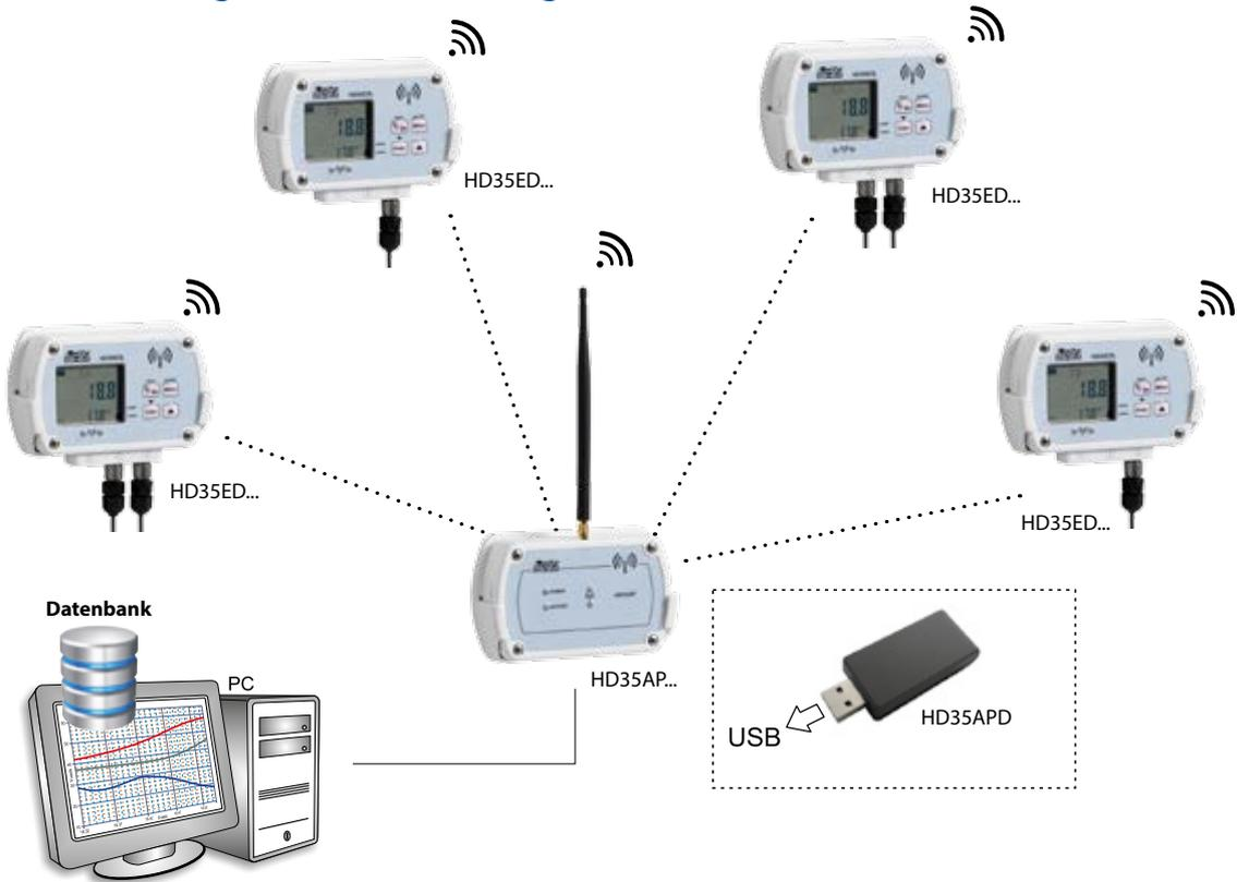
Verbindung von PC und Basiseinheit über ETHERNET des lokalen Netzwerks
