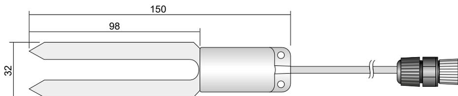
**HP3510.2.5** Sensor mit 3 Elektroden zur Messung der Bodenfeuchte bei begrenztem Volumen. Mit integriertem NTC 10 k $\Omega$  Temperatursensor. M12 Verbinder. 5 m Kabel.
