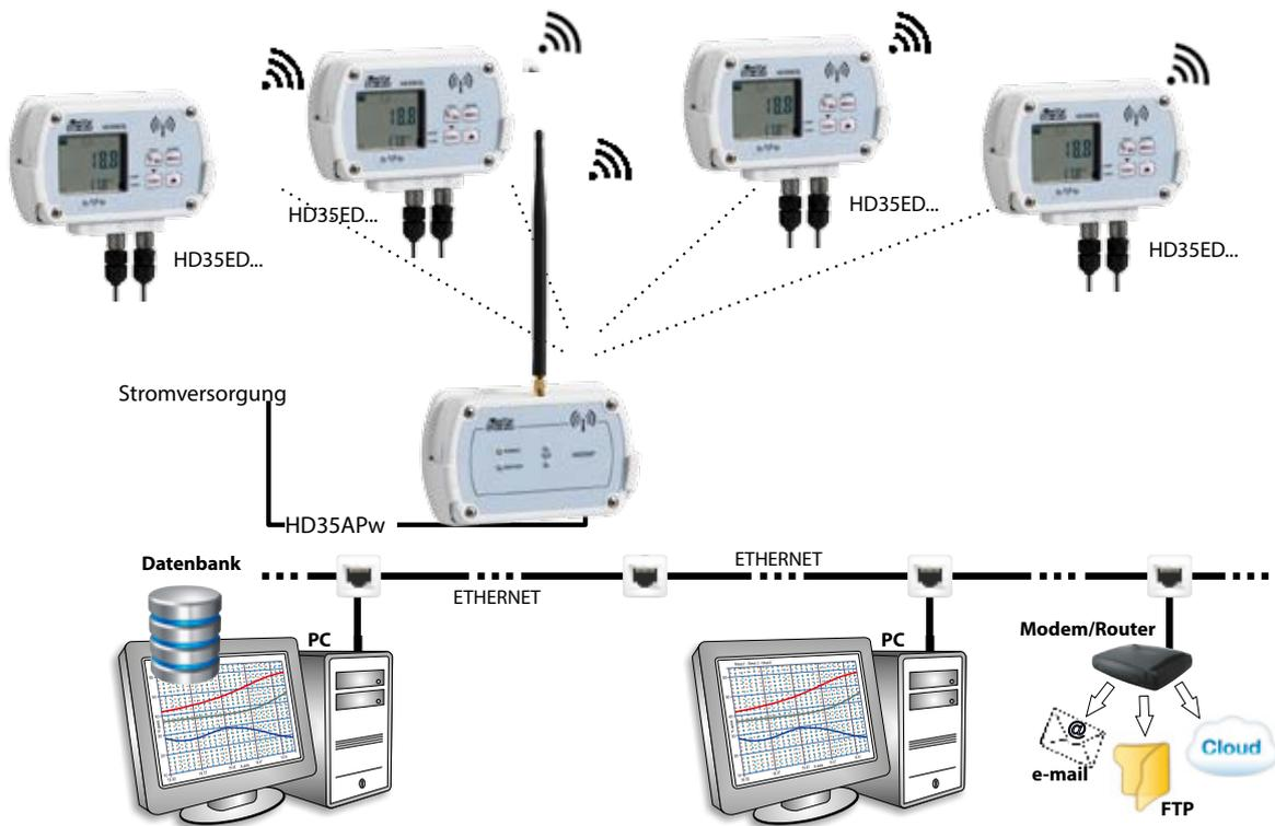
Verbindung von PC und Basiseinheit über WLAN des lokalen Netzwerks
