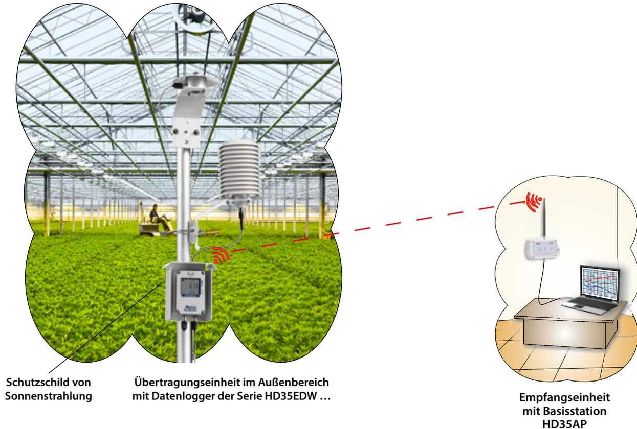
Das Gehäuse der wasserdichten Versionen kann an einer Wand oder im Falle der Installation im Freien an einem Mast mit 40 mm Durchmesser mittels der HD2003.77/40 Montageklemme montiert werden. Bei Aufstellung im Freien kann der Datenlogger mit dem **Schutzschild von Sonnenstrahlung** geliefert werden.
