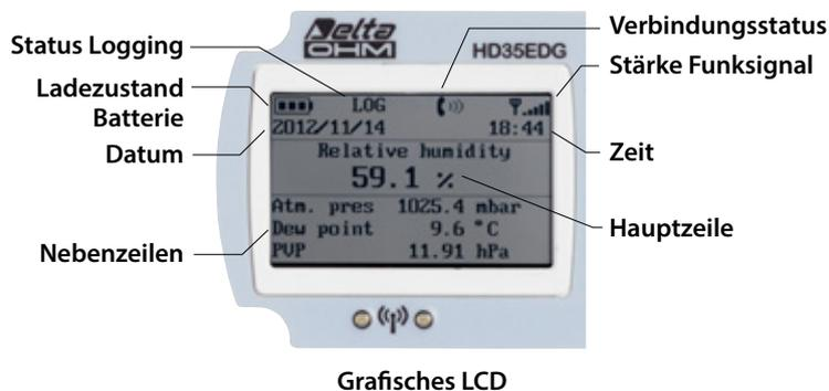
Die Datenlogger mit LCD können Messwerte in verschiedenen Maßeinheiten anzeigen. Bei den Modellen, die die Temperatur messen, kann der Benutzer °C oder °F einstellen, bei den Modellen, die den atmosphärischen Druck messen, kann zwischen den Maßeinheiten hPa (= mbar), mmHg, inchHg, mmH<sub>2</sub>O, inchH<sub>2</sub>O, atm gewählt werden.
