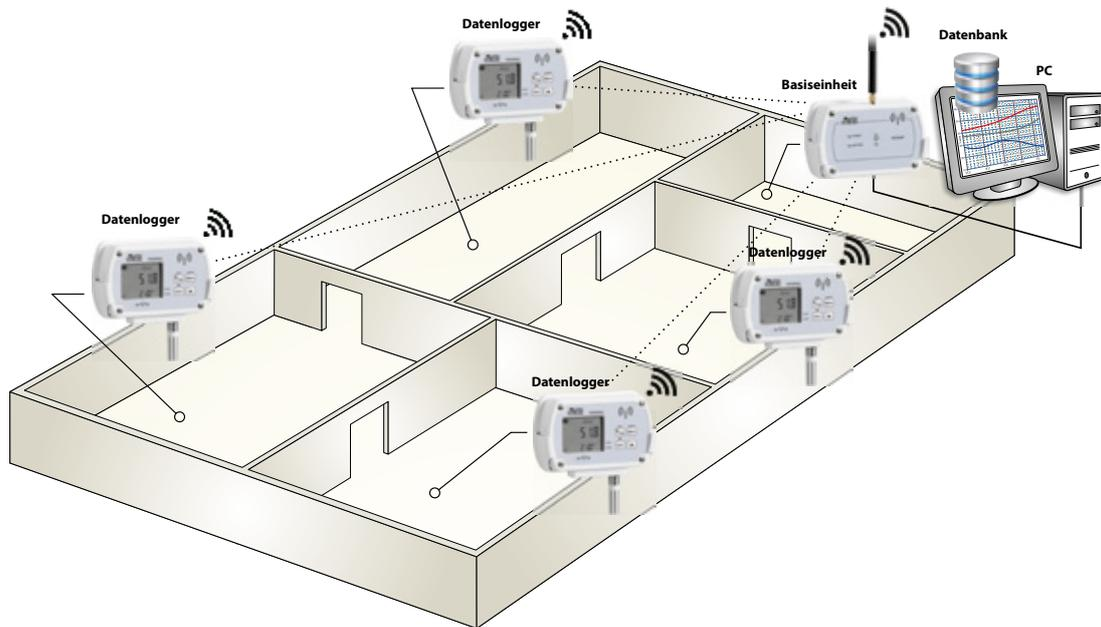
Beispiel für die Überwachung einer Einrichtung mit unterschiedlichen Bereichen
