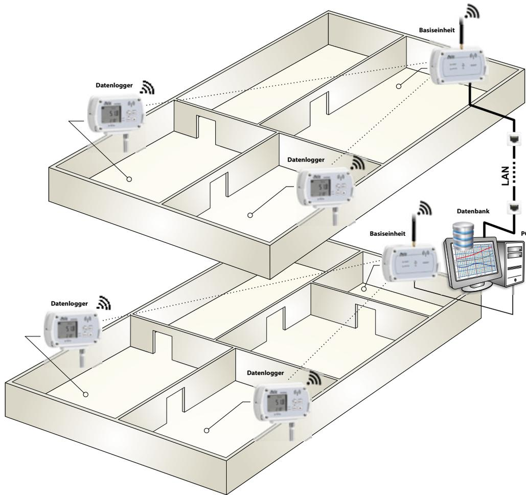
Beispiel für die Überwachung eines mehrstöckigen Gebäudes:
