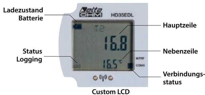
Die Modelle mit grafischem LCD erlauben das Anzeigen von 3 Messwerten gleichzeitig in den Nebenzeilen. Am grafischen Display werden auch die Stärke vom Funksignal, Datum und Uhrzeit angezeigt.
