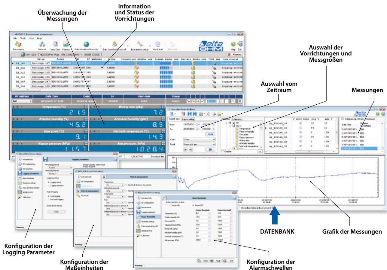
Die Verbindung mit der Datenbank ist vom Typ **Multi-Client**: Die Daten können in einer remoten Datenbank im lokalen Netzwerk gespeichert werden, mit dem der PC verbunden ist, und dann an jedem PC im lokalen Netzwerk angezeigt werden, auf dem die Software HD35AP-S installiert ist.
