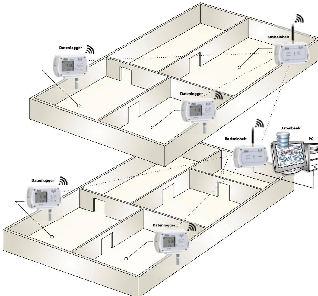
Beispiel für die Überwachung eines mehrstöckigen Gebäudes:
